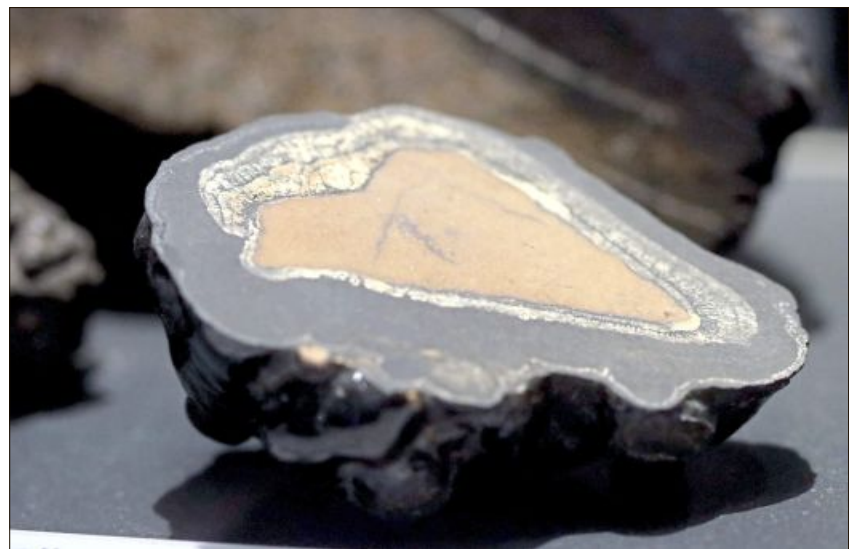
So sieht eine Manganknolle aus, wenn man sie aufschneidet.
